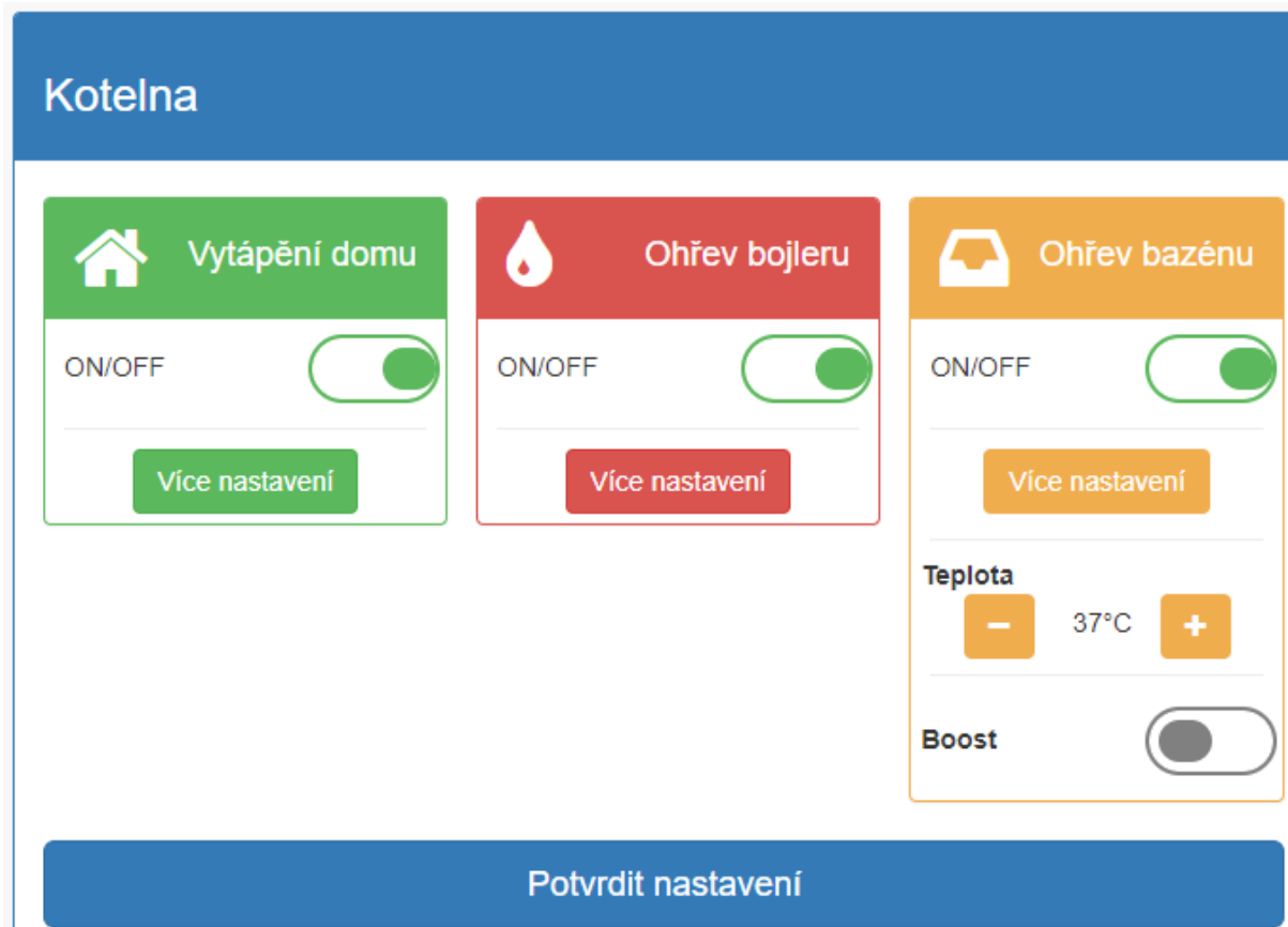
Obrázek č. 4d – Rozšířené vytápění bazénu
